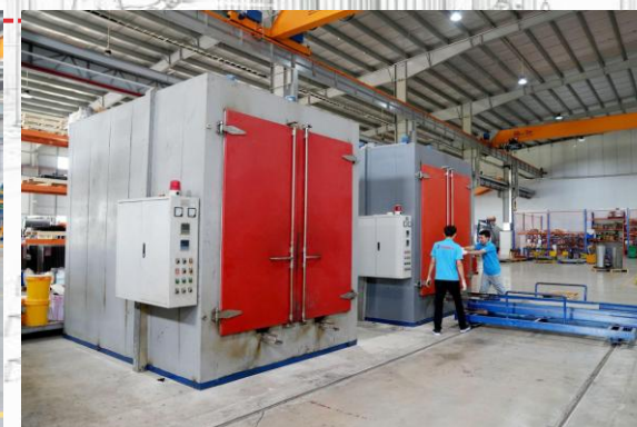
SẤY KHÔ RUỘT MÁY Core drying
