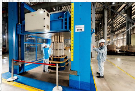
ÉP, ĐỊNH HÌNH & HOÀN THIỆN CUỘN DÂY Coil pressing & finishing
