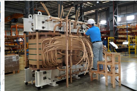
LẮP RÁP RUỘT MÁY & ĐẦU NỐI NỘI BỘ Core & coil assembly, internal connections
