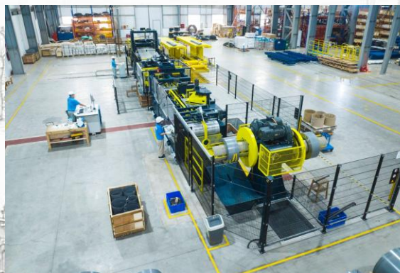
CẮT TÔN SILIC - DÂY CHUYỀN CẮT TÔN Core cutting - Sheet metal cutting line
