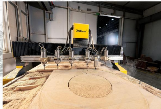
GIA CÔNG CHẾ TẠO CÁC CHI TIẾT CÁCH ĐIỆN Insulation components manufacturing
