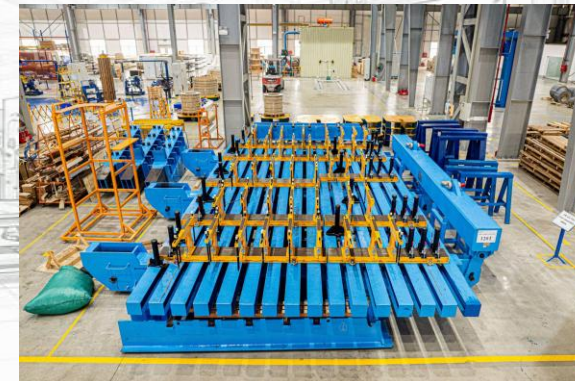
LẮP RÁP LỖI THÉP Core assembly / staking
