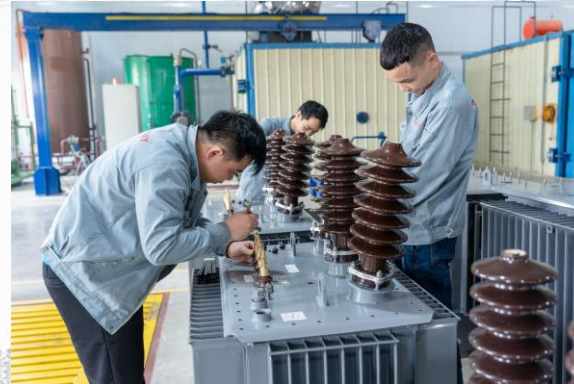
LẮP VÀO THÙNG & HOÀN THIỆN CƠ KHÍ Tank assembly & Mechanical completion
