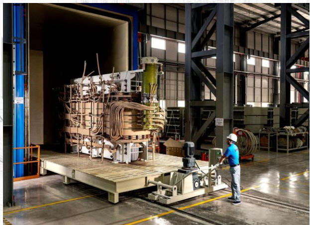
SẤY KHÔ RUỘT MÁY Core drying
