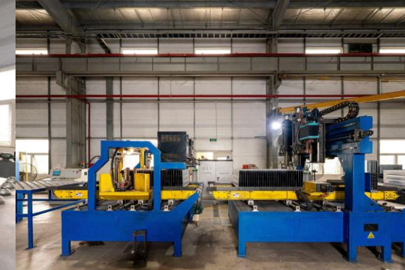
DÂY CHUYỂN CHẾ TẠO CÁNH TÀN NHIỆT Sheet metal processing
