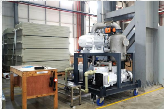
HÚT CHÂN KHÔNG & XỬ LÝ DẦU CÁCH ĐIỆN Vacuum oil filling process
